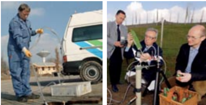
Zum Nachsorgekonzept von Stadt Leverkusen, Bayer und Bundesstraßenverwaltung gehören regelmäßige Kontrollen (hier Bodenluftmessung).
