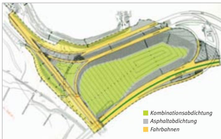
Die Oberflächenabdichtung im Bereich des Autobahnkreuzes Leverkusen-West setzt sich aus einer Kombinationsabdichtung im flachen Gelände, einer Asphaltabdichtung in den Böschungsbereichen und den bereits dichten Fahrbahnen zusammen.
